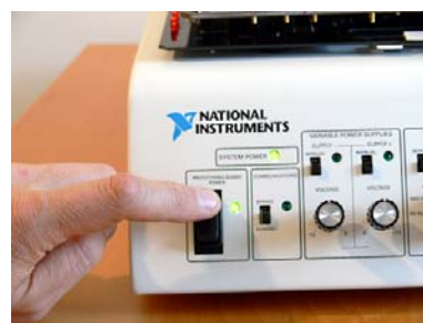
Переведите переключатель питания макетной платы в положение ВКЛЮЧЕНО (ON)
