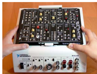
Осторожно надавите на плату, чтобы она вошла в разъем
