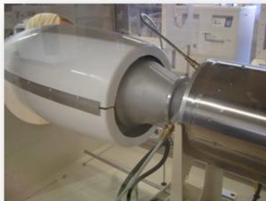
Рисунок 1.5 Глушитель всасывания HushKit, сопряженный с раструбом воздухозаборника двигателя SR-30. Теперь можно накачивать надувное уплотнение.
