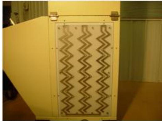
Рисунок 5.3: Резистивная ячейка – основная нагрузка генератора
