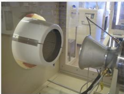
Рисунок 1.4 Глушитель всасывания HushKit должным образом ориентирован на воздухозаборнике двигателя SR-30
