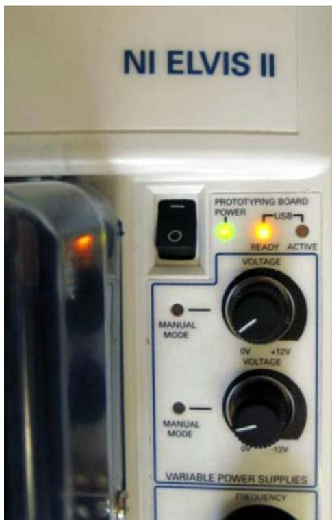
Рис. 9. Индикаторы POWER и READY на станции NI ELVIS
