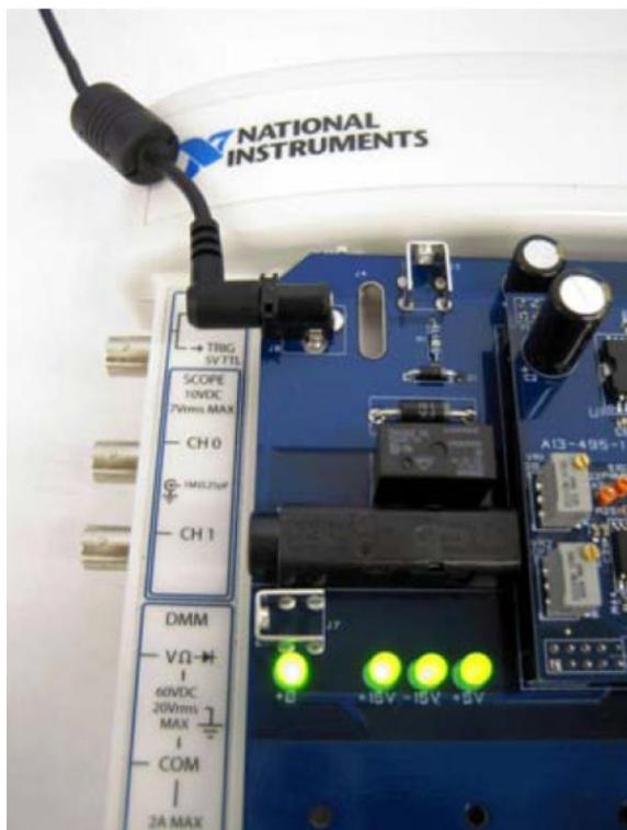
Рис. 10. Все индикаторы на модуле QNET должны светиться
