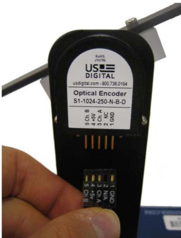
Рис. 38. Подключение кабеля к энкодеру.
