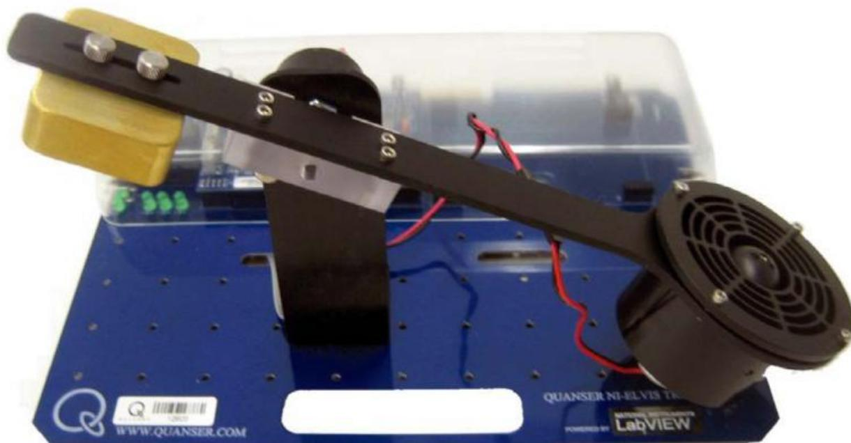
Рис. 39. Полностью собранная система QNET-VTOL
