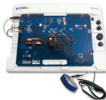
*Рис. 6. Модуль QNET-MYO-ELECTRIC*
