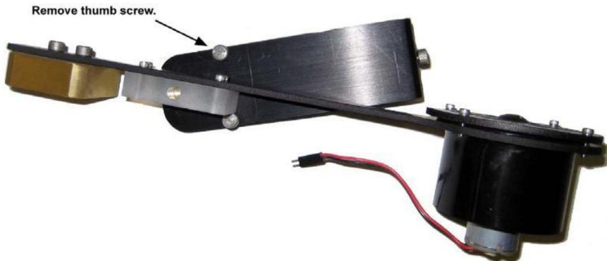
Рис. 33. Выверните винт из опоры
