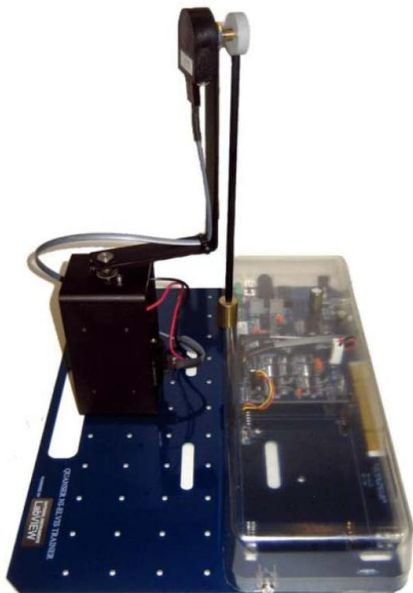
Рис. 22. Установите маятник вертикально на модуле *ROTPENT* и совместите отверстия под винты
