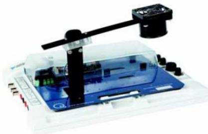
*Рис. 5. Модуль QNET-VTOL*
