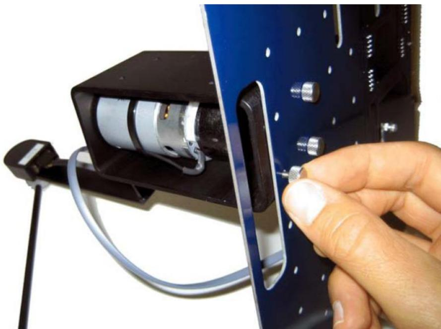
Рис. 23. Затягивание четырех винтов
