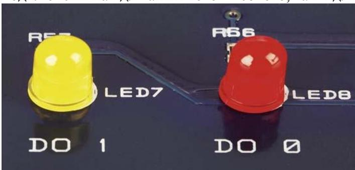
Рис. 9.22. Светодиоды на тренажере QNET с мехатронными датчиками
