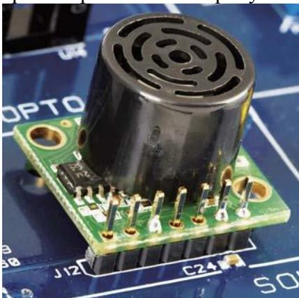
Рис. 9.14. Звуковой датчик на тренажере QNET с мехатронными датчиками
