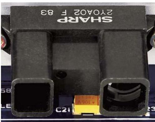
Рис. 9.15. Инфракрасный датчик на тренажере QNET с мехатронными датчиками
