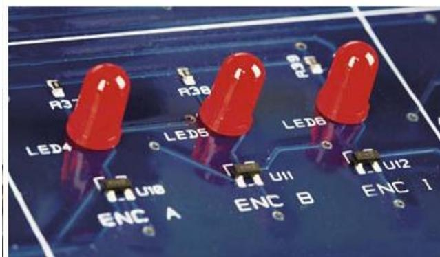
Рис. 9.9. Светодиоды энкодера на тренажере QNET с мехатронными датчиками
