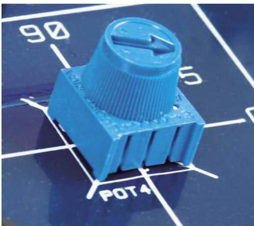
Рис. 9.5. Рукоятка потенциометра в тренажере QNET с мехатронными датчиками
