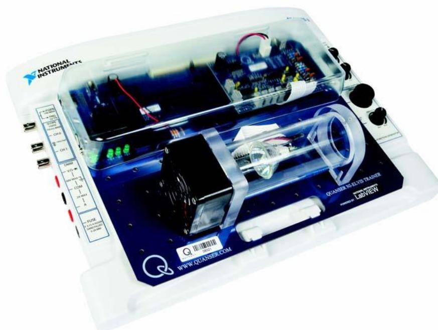
Рис. 5.1. Тренажер QNET для изучения процессов управления нагреванием и вентиляцией (HVACT)
