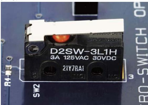
Рис. 9.18. Микропереключатель на тренажере QNET с мехатронными датчиками
