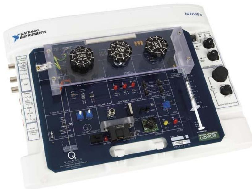
Рис. 9.1. Тренажер QNET с мехатронными датчиками
