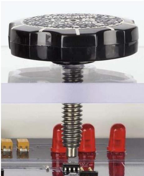
Рис 9.17. Преобразователь магнитного поля на тренажере QNET с мехатронными датчиками
