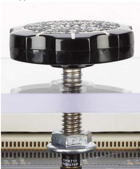
Рис. 9.16. Оптический датчик положения (снизу) и рукоятка положения цели (сверху) на тренажере QNET с мехатронными датчиками
