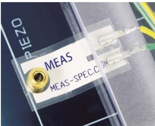
Рис. 9.3. Пьезодатчик на тренажере с мехатронными датчиками QNET
