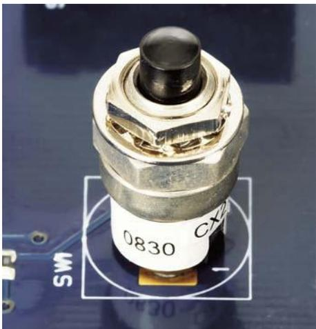
Рис. 9.19. Нажимная кнопка на тренажере QNET с мехатронными датчиками
