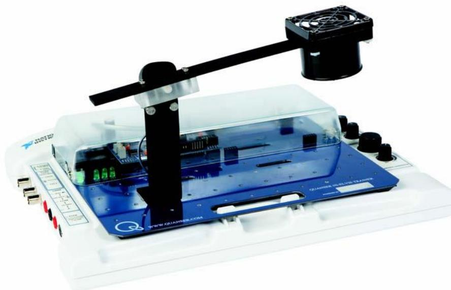
Рис. 8.1. Тренажер вертикального взлета и посадки QNET VTOL
