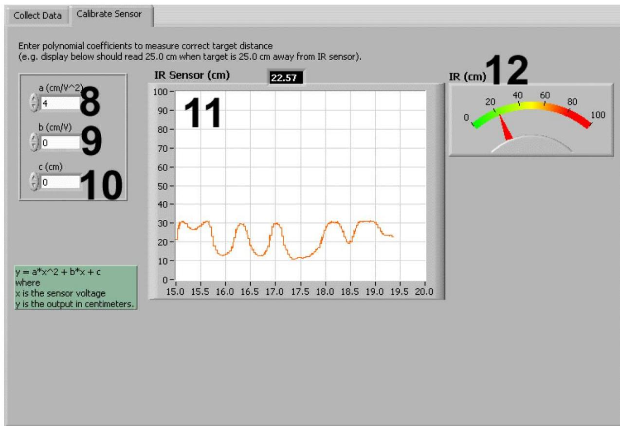
Рис. 12. VI QNET MECHKIT Infrared: выбрана закладка “Calibrate Sensor”
