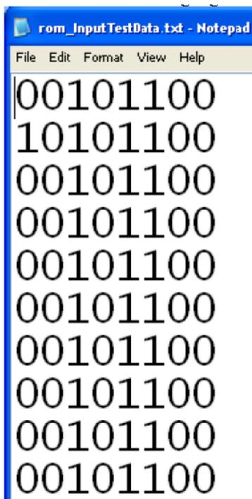
В соответствии с этим входным файлом канал DIO8 назначен в качестве кнопки Go, а каналы с DIO9 по DIO15 – используются для задания шаблона поиска Pattern [6:0]. Файл выходных данных – тоже текстовый, и его тоже можно открыть/создать любым текстовым редактором. На следующем рисунке показано содержимое этого файла
