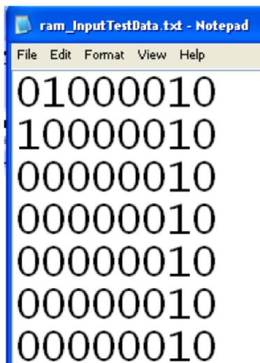
В соответствии с этим входным файлом канал DIO8 назначен в качестве кнопки Read\_Go, канал DIO9 назначен в качестве кнопки Write\_Go, а каналы с DIO10 по DIO15 – используются для задания начальных данных [5:0]. Файл выходных данных – тоже текстовый, и его тоже можно открыть/создать любым текстовым редактором. На следующем рисунке показано содержимое этого файла
