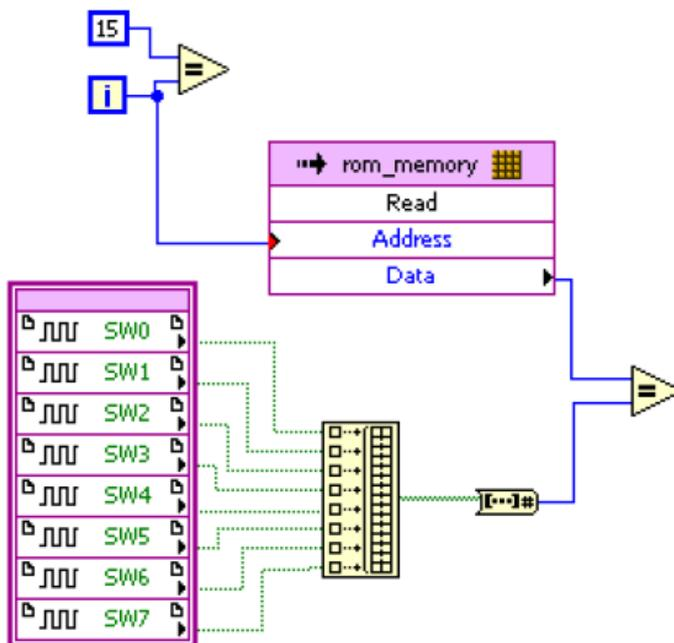
Т.к. мы хотим останавливать выполнение задачи при обнаружении требуемого шаблона или при заполнении счетчика, нам необходимо добавить некоторую логику. Нам также нужно добавить индикацию сигналов Done, Success и Fail, подключив их к соответствующим светодиодам (LED)
