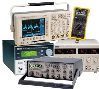
В то же время, найдется очень мало лабораторий или мастерских, в которых работают с электронными устройствами, где нет таких приборов, как *Источник питания постоянного тока (DC Power Supply)* или *Генератор функций (Function Generator)*. Помимо того, что источник напряжения постоянного тока может выдавать тестовые сигналы, он еще может использоваться для питания тестируемого оборудования. Генератор функций используется для получения различных тестовых сигналов переменного тока.
