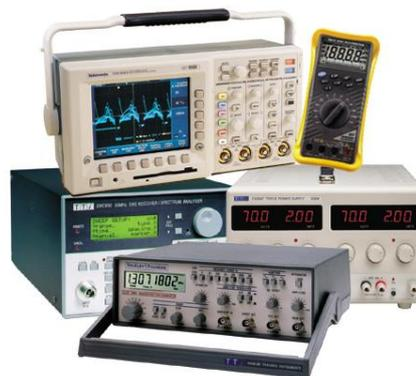
В то же время, найдется очень мало лабораторий или мастерских, в которых работают с электронными устройствами, где нет таких приборов, как *Источник питания постоянного тока (DC Power Supply)* или *Функциональный Генератор (Function Generator)*. Помимо того, что источник напряжения постоянного тока может выдавать тестовые сигналы, он еще может использоваться для питания тестируемого оборудования. Функциональный Генератор используется для получения различных тестовых сигналов переменного тока.
