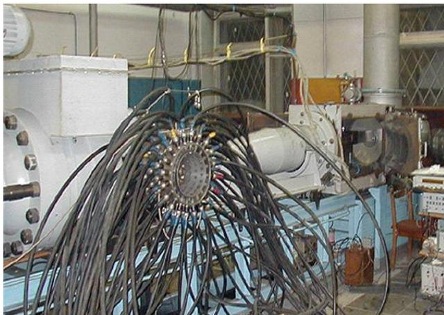
Рис. 1. Импульсная аэродинамическая труба ИТ-302М ИТПМ СО РАН
