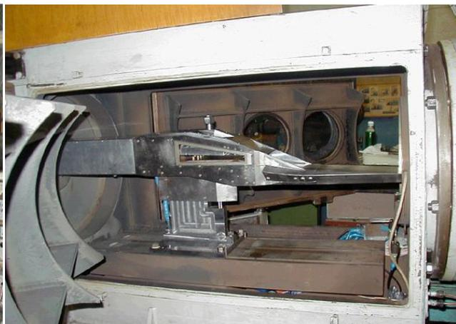
Рис. 2. Модель ГЛА в рабочей части импульсной аэродинамической трубы
