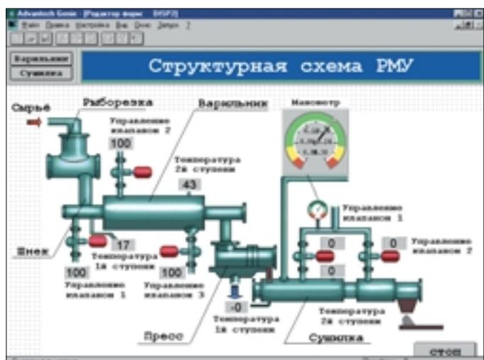
**Рис. 8. Мнемосхема технологического процесса, сформированная в среде Genie**
