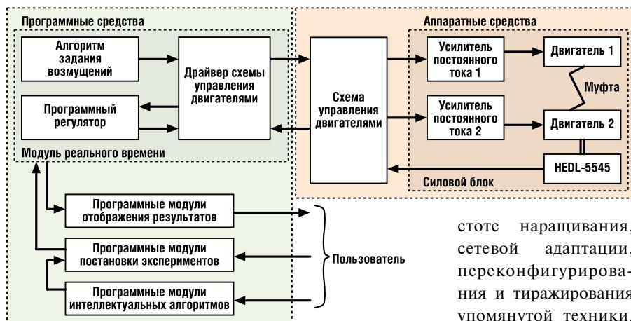
Рис. 10. Структура комплекса аппаратно-программных средств для исследования быстродействующих интеллектуальных приводов
