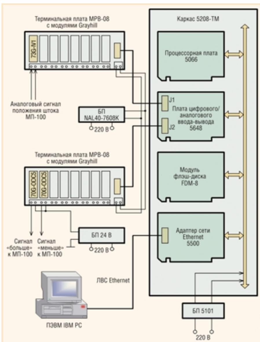
Условные обозначения: БП — блок питания; МП-100 — механизм перемещения.
