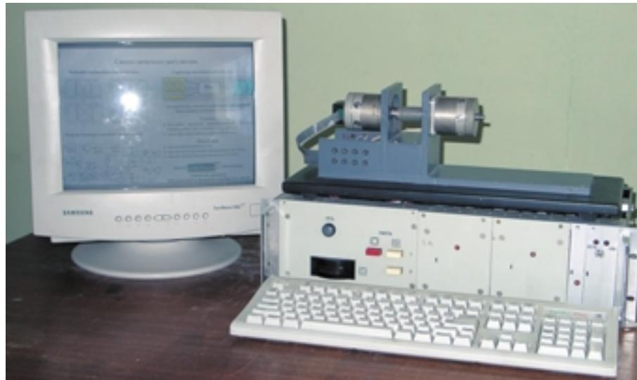
Рис. 9. Комплекс для исследования быстродействующих интеллектуальных приводов
