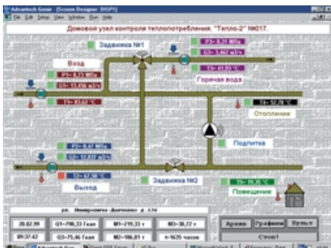
Рис. 6. Мнемосхема системы контроля теплопотребления, разработанной в среде Genie в рамках курсового проекта
