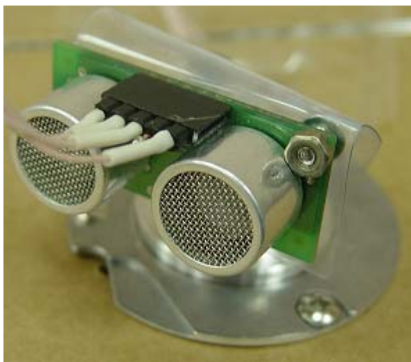
Рис.1. Ультразвуковой датчик на валу шагового двигателя
