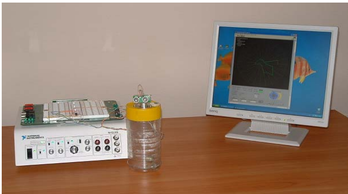
Рис.3. Лабораторный стенд "Ультразвуковой радар"
